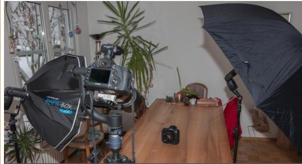
11.) Gleicher Aufbau wie 10. Blitzbelichtungskorrektur auf der Octabox bei -1,3 Blendenstufen.
